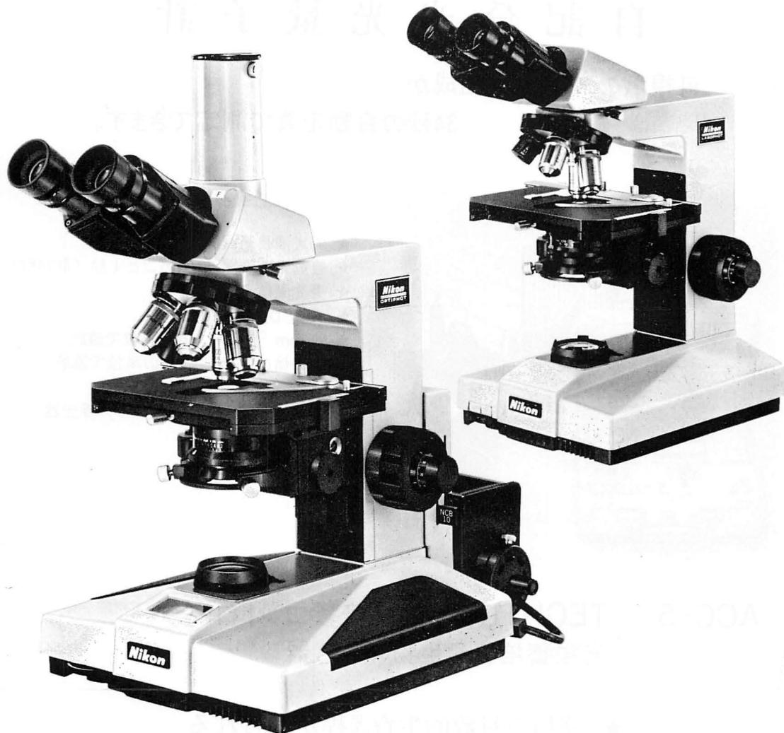
**OPTIPHOT** ● 対物レンズ・接眼レンズには好評の光学系、CFシステムを採用。より鮮鋭な像が観察・撮影できます。● 照明系には、理想ケーラー照明装置・輝度の高い12V50Wハロゲンランプを採用。低倍から高倍まで切り換えなしで、自然色で明るいシャープな像が得られます。● 三眼鏡筒Fは、双眼部と連動したプリズムはねのけ式により、鮮鋭な写真が撮影できる設計です。
