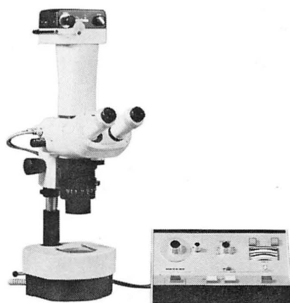
ウILD M400型 フォトマクروسコープ 明暗視野スタンド付
