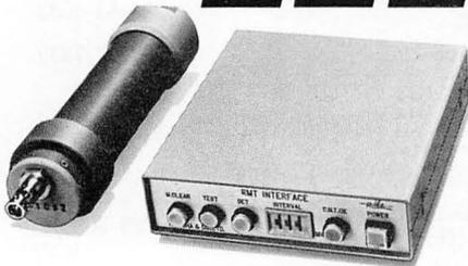
測定間隔は1~127分まで、1分ごとに設定できます。本装置は、海洋、河川、湖沼、水槽やいけすなど、表層から水深500mまでの水温観測ができるデジタルメモリー式の水温計です。水温度計本体は、携帯、保管、取り付けが簡便で、連装して取り付けることにより、細かい水平、鉛直水温分布などの観測が容易に行なえます。また、他の機器に簡単に取り付けられることもできます。水温度計の測定間隔は、1~127分まで1分ごとに設定でき、設定された測定間隔ごとに水温を自動計測し、ICメモリーに記憶します。
