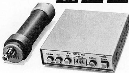
測定間隔は1~127分まで、1分ごとに設定できます。本装置は、海洋、河川、湖沼、水槽やいけすなど、表層から水深500mまでの水温観測ができるデジタルメモリー式の水温計です。水温計本体は、携帯、保管、取り付けが簡便で、連装して取り付けることにより、細かい水平、鉛直水温分布などの観測が容易に行なえます。また、他の機器に簡単に取り付けすることもできます。水温計の測定間隔は、1~127分まで1分ごとに設定でき、設定された測定間隔ごとに水温を自動計測し、ICメモリーに記憶します。
