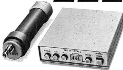
測定間隔は1~127分まで、1分ごとに設定できます。本装置は、海洋、河川、湖沼、水槽やいけすなど、表層から水深500mまでの水温観測ができるデジタルメモリー式の水溫計です。水溫計本体は、携帯、保管、取り付けが簡便で、連装して取り付けることにより、細かい水平、鉛直水温分布などの観測が容易に行なえます。また、他の機器に簡単に取り付けすることもできます。水溫計の測定間隔は、1~127分まで1分ごとに設定でき、設定された測定間隔ごとに水温を自動計測し、ICメモリーに記憶します。
