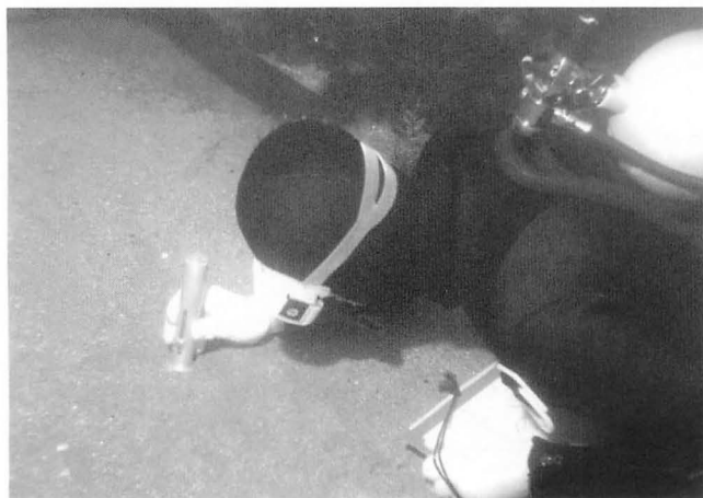
図3 土壌硬度計を基盤に垂直に押しつけ、反発力（支持強度）で基盤硬度の測定（砂泥基盤の例）
