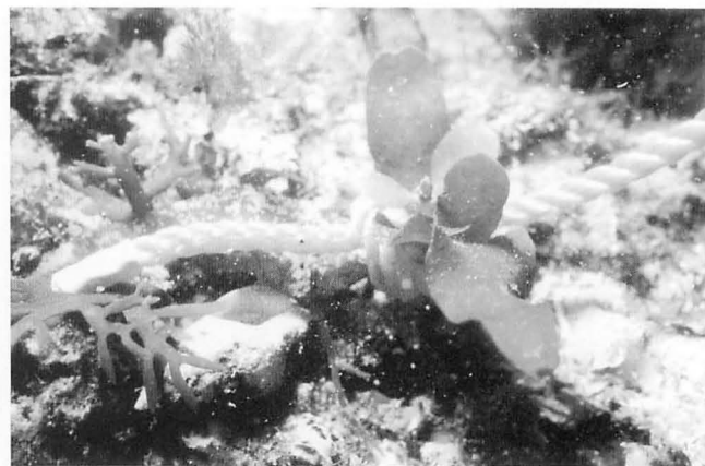
図4 海草・藻体の基部にくくりつけたロープをバネばかりで 45^\circ 方向へ引っ張り、引張強度で基盤への固着力の測定（フシシジモク幼体の例）
