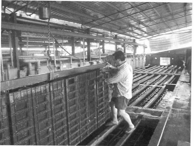
図 2 クレーンで引き上げられた網籠この状態で，清掃が行われて，籠の側面の口から，ドライペレットを入れる
