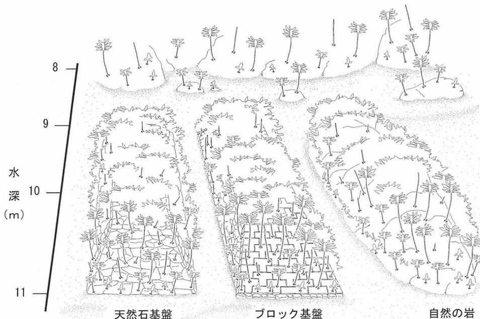
図3 神奈川県横須賀市秋谷地先の水深11mの砂泥底に設置された石積みマウンドと比較対照とした自然の岩における藻場の景観模式図(2004年11月)
