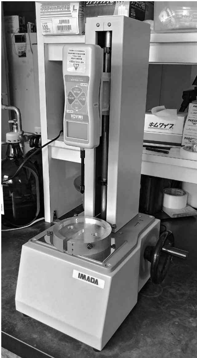
藻体の頑丈さを計測するフォースゲージ
